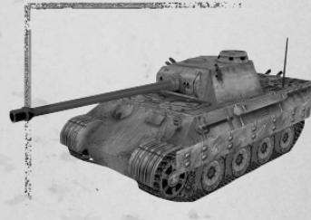
Die Ingenieure hatten darüber hinaus in Sachen Fahrwerk beste Arbeit geliefert, denn in Sachen Dämpfung und Federung konnte kein Panzer des zweiten Weltkrieges dem Panther das Wasser reichen. Trotz des Rückstoßes beim Schießen konnte der Panther-Schütze genau zielen.
