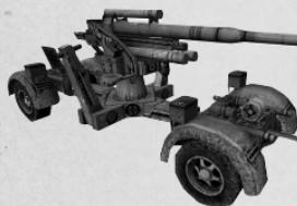
Man nehme eine 88mm Flugabwehrkanone, senke das Kanonenrohr um 90 Grad nach unten, und schon hat man eine der schlagkräftigsten Anti-Panzer Geschütze des zweiten Weltkrieges.
