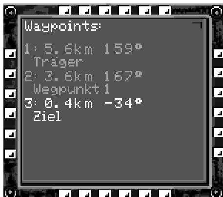
Wegpunkte beschreiben die anzufliegenden Ziele. Mit < W > bzw. < Shift W > können die Wegpunkte durchgeschaltet werden. Der angewählte Wegpunkt mit Entferungs- und Richtungsangabe hat eine rote Schrift. Die Flugstrecke bis dahin wird anschließend auf der Karte mit gestrichelten Linien dargestellt.
