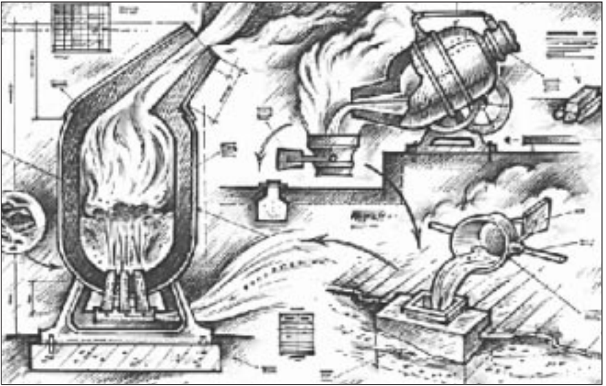
Bessemerbirne. Henry Bessemer entwickelte ein Verfahren zur Produktion von preiswertem hochgradigem Stahl, indem er heiße Luft von unten in ein Faß mit flüssigem Eisen leitete, wodurch der darin enthaltene Kohlenstoff entfernt wurde.
